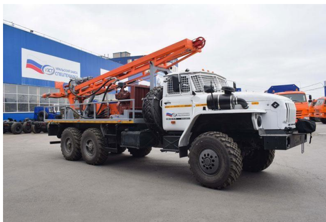
Рисунок 5.3 – Буровая установка УРБ-2А2
